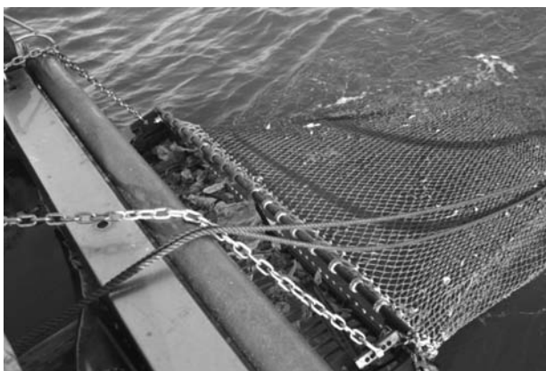
写真3 回収に用いる底曳き網
